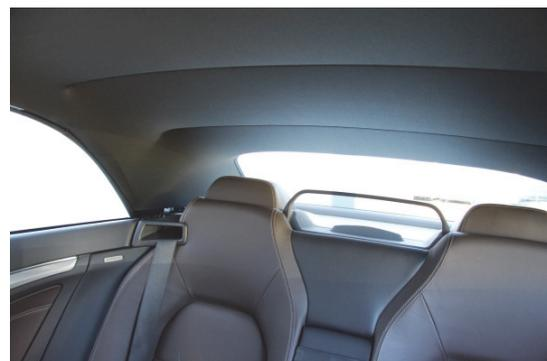
Die feststehenden Kopfstützen sowie die breite Verdeckkonstruktion verhindern eine gute Sicht nach hinten.
