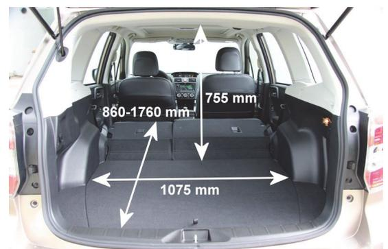
Der Kofferraum mit 370 l Volumen ist gegenüber dem Vorgängermodell (395 l) etwas kleiner ausgefallen.
