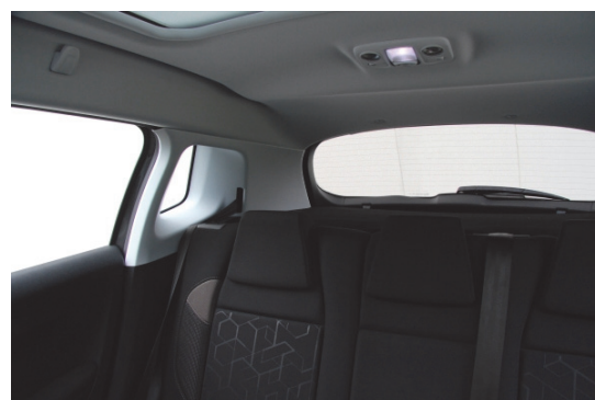
Die breiten Dachsäulen schränken die Sicht stark ein.
