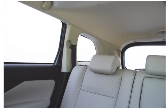
Breite Dachsäulen und nicht versenkbare Kopfstützen verhindern eine gute Sicht nach hinten.
