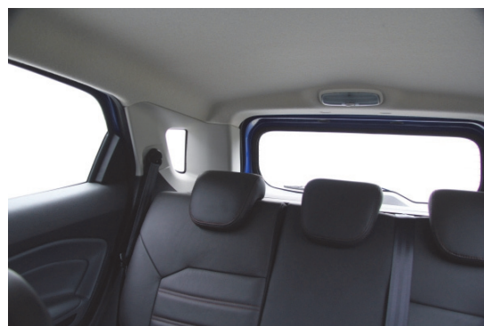
Trotz teilversenkbarer Kopfstützen wird die Sicht nach schräg hinten durch die breiten Dachsäulen beeinträchtigt.
