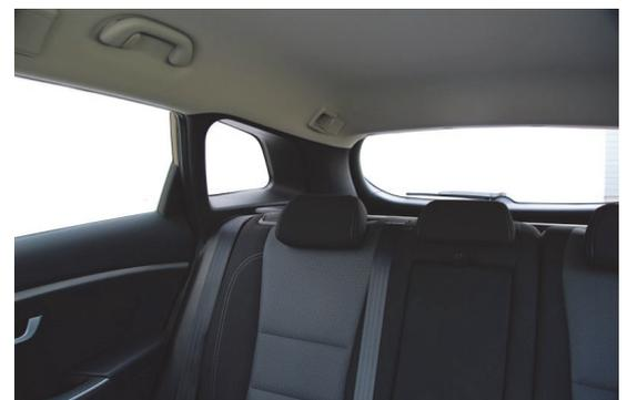
**Die versenkbaren Kopfstützen verbessern die Sicht nach hinten, die breiten Dachsäulen beeinträchtigen aber den Blick nach schräg hinten sehr**
