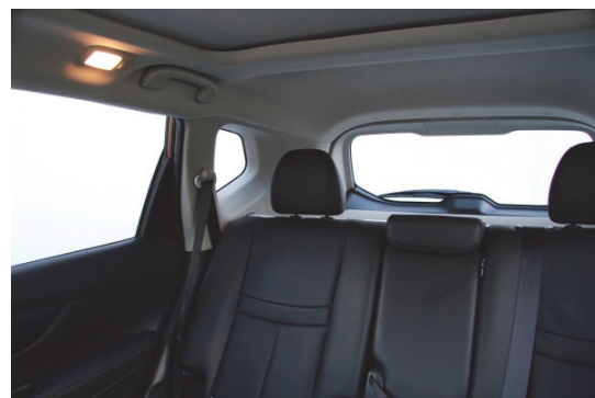
Durch die nicht versenkbaren Kopfstützen und die breiten Dachsäulen ist die Sicht nach schräg hinten erheblich eingeschränkt.
