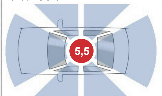
Durch die nicht versenkbaren Kopfstützen und die breiten Dachsäulen ist die Sicht nach schräg hinten erheblich eingeschränkt.
