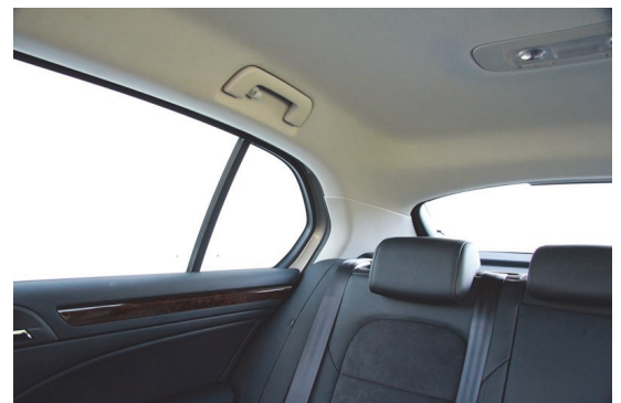
Breite Dachsäulen und eine hoch angesetzte Fensterunterkante verhindern eine ausreichende Sicht nach hinten.
