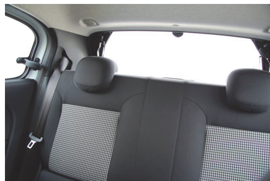
Breite Dachsäulen schränken die Sicht nach schräg hinten ein.
