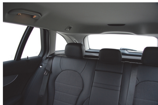
Die Sicht nach schräg hinten wird durch breite Dachsäulen und nicht versenk- oder klappbare Kopfstützen beeinträchtigt.
