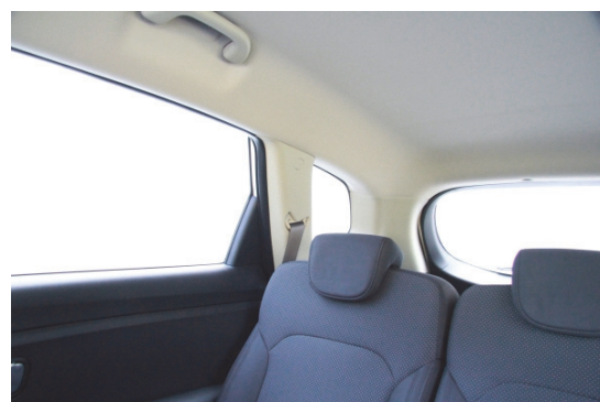
Versenkbare Kopfstützen verbessern die Sicht. Die breiten Dachsäulen erschweren dagegen die Sicht nach schräg hinten.
