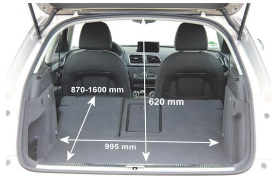
**Der Kofferraum fasst aufgrund eines Wendeladebodens nur noch 310 l Gepäck. Ohne dieses optionale Extra kann der Kofferraum des Q3 mit 435 l Volumen sogar den größeren Bruder Q5 um 30 l übertrumpfen.**
