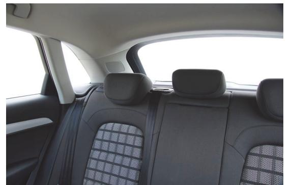
**Vor allem die breiten Dachsäulen sowie nicht versenkbare Kopfstützen schränken die Sicht nach schräg hinten erheblich ein.**
