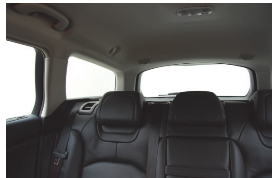
Versenkbare Kopfstützen erleichtern die Sicht nach hinten.
