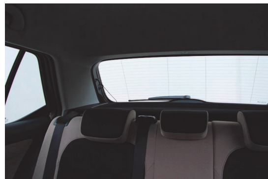
Versenkbare Kopfstützen erleichtern die Sicht nach schräg hinten.
