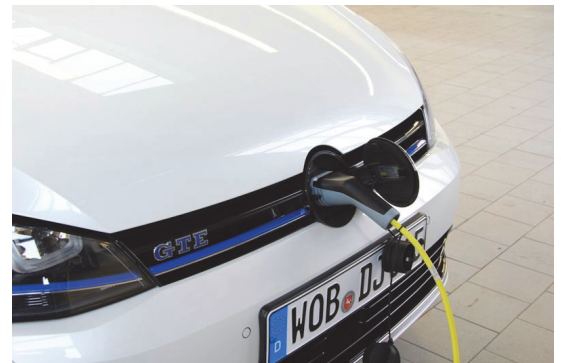
Unter dem VW-Emblem an der Fahrzeugfront verbirgt sich die Ladesteckdose.
