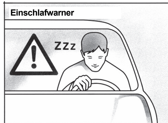
Einschlafwarner Ungewöhnliche Fahrerreaktionen aufgrund von Müdigkeit werden erkannt und führen zu einer Warnung.
