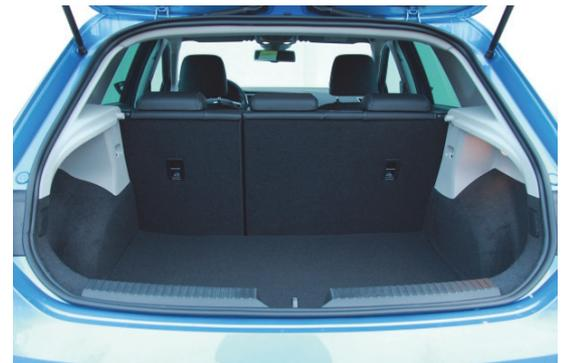
Mit nur 255 l Volumen ist der Kofferraum des TGI deutlich kleiner als bei den herkömmlich angetriebenen Modellen.
