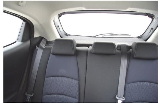
**Massive Dachsäulen und ein kleines, hoch angesetztes Heckfenster beeinträchtigen die Sicht nach hinten.**
