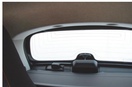
Breite Dachsäulen und die schmale Heckscheibe beeinträchtigen die Sicht nach schräg hinten.
