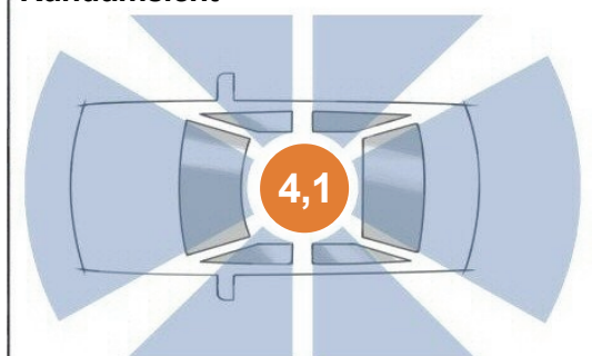
Besonders nach schräg hinten ist die Sicht durch breite Dachsäulen und nicht versenkbare Kopfstützen stark eingeschränkt.
