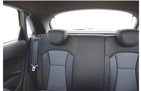
Versenkbare Kopfstützen und nicht zu breite Dachsäulen erleichtern die Sicht nach hinten.
