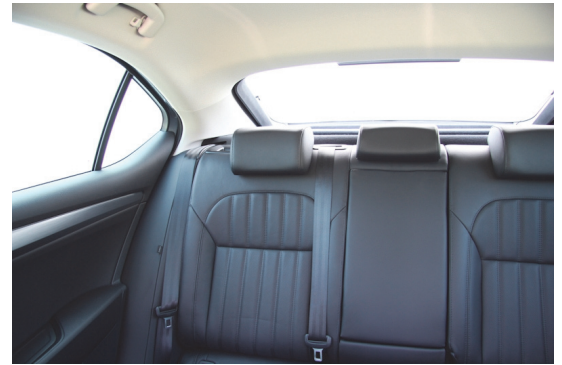
Versenkbare Kopfstützen sollten die Sicht nach hinten verbessern, wird allerdings durch breite Dachsäulen und eine relativ hohe Rücksitzbanklehne verhindert.
