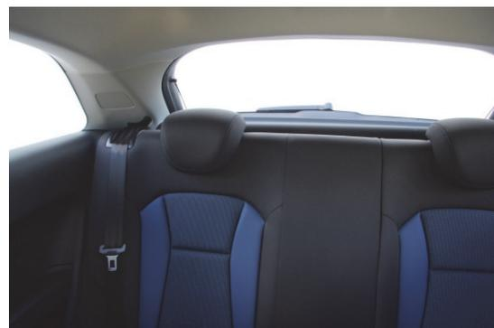
Versenkbare Kopfstützen und nicht zu breite Dachsäulen erleichtern die Sicht nach hinten.
