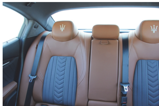
Breite Dachsäulen und nicht versenkbare Kopfstützen verhindern eine ausreichende Sicht nach schräg hinten.
