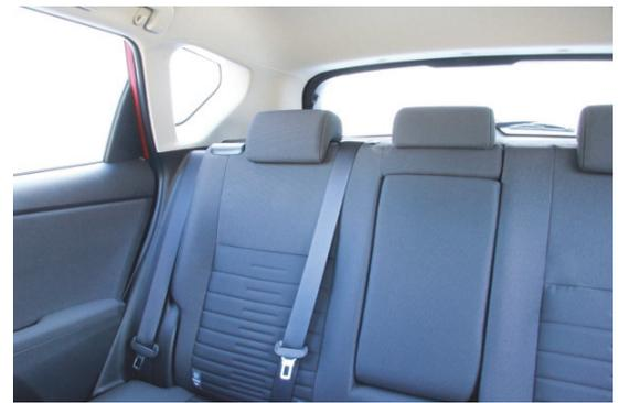
Breite Dachsäulen und nicht vollständig versenkbare Kopfstützen verhindern eine gute Sicht nach schräg hinten.
