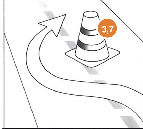
Beim ADAC-Ausweichtest erfolgt die Einfahrt in die Pylonengasse mit einer Geschwindigkeit von 90 km/h bei mindestens 2000 Motorumdrehungen im entsprechenden Gang. Geprüft wird die Fahrzeugreaktion, d.h. die Beherrschbarkeit beim anschließenden Ausweichen.
