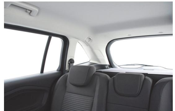
**Kleine Sichtfenster zwischen den Dachsäulen verbessern die Sicht nach schräg hinten.**
