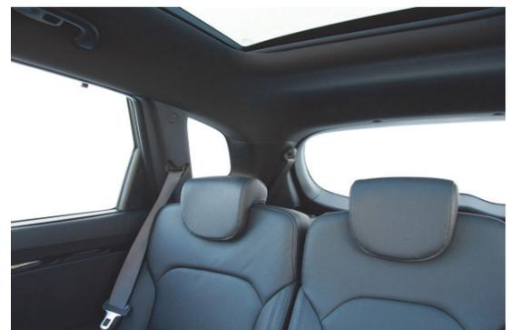
**Versenkbare Kopfstützen verbessern die Sicht. Die breiten Dachsäulen erschweren dagegen die Sicht nach schräg hinten.**
