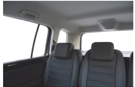
Besonders nach schräg hinten ist die Sicht aufgrund der nicht voll versenkbaren Fondkopfstützen und relativ breiter Dachsäulen erheblich eingeschränkt.
