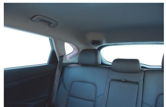
**Breite Dachsäulen, nicht versenkbare Kopfstützen sowie eine hohe Fensterunterkante verhindern eine gute Sicht nach hinten.**
