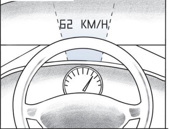
In die Windschutzscheibe werden Geschwindigkeit, Navigationshinweise und andere Informationen eingespiegelt. Dadurch muss der Blick nicht mehr so stark von der Straße nach unten auf den Tacho gesenkt werden, außerdem entfällt die Anpassung der Augen (Akkommodation) auf die unterschiedlichen Entfernungen von Fahrbahn und Kombi-Instrument.
