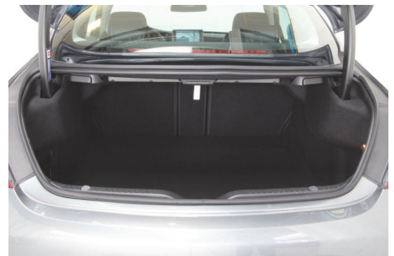
Der Kofferraum ist mit 340 l Volumen um 20 l kleiner als das Gepäckabteil der Limousine.
