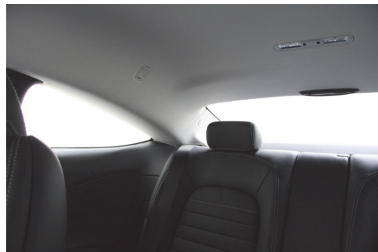
Breite Dachsäulen und nicht abklappbare Kopfstützen behindern die Sicht nach schräg hinten.
