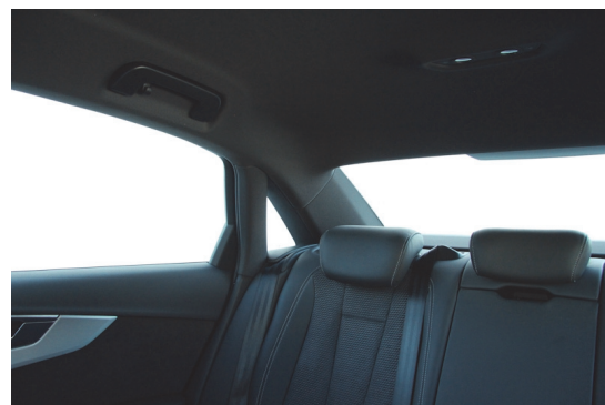
Die versenkbaren Kopfstützen verbessern die Sicht nach hinten.
