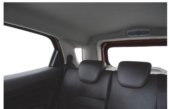
**Trotz teilversenkbarer Kopfstützen wird die Sicht nach schräg hinten durch die breiten Dachsäulen beeinträchtigt.**
