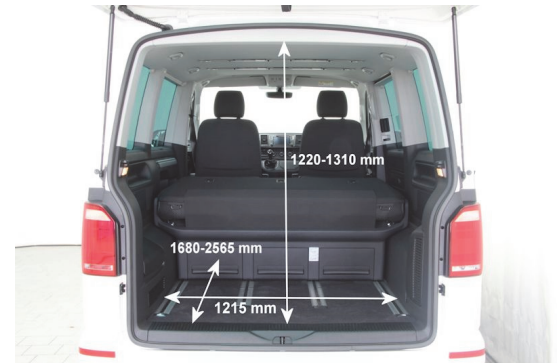
Bei voller Besetzung stellt der VW Multivan immer noch üppige 705 Liter Kofferraumvolumen zur Verfügung.
