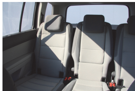
Besonders nach schräg hinten ist die Sicht aufgrund der nicht voll versenkbaren Fondkopfstützen und relativ breiter Dachsäulen erheblich eingeschränkt.
