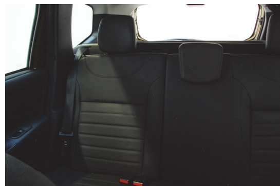
Sehr breite Dachsäulen und die nicht versenkbaren Kopfstützen erschweren die Sicht nach schräg hinten erheblich.
