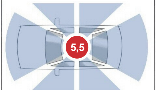
Durch das Verdeck und die schmale Heckscheibe ist die Sicht nach hinten extrem eingeschränkt.
