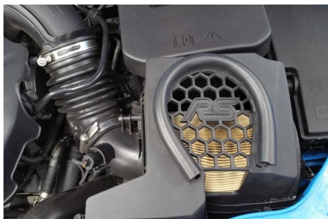
Um dem leistungsstarken Motor genügend Luft zur Verfügung zu stellen, sind der Luftfilterkasten und das Filterelement für hohen Durchlass optimiert.
