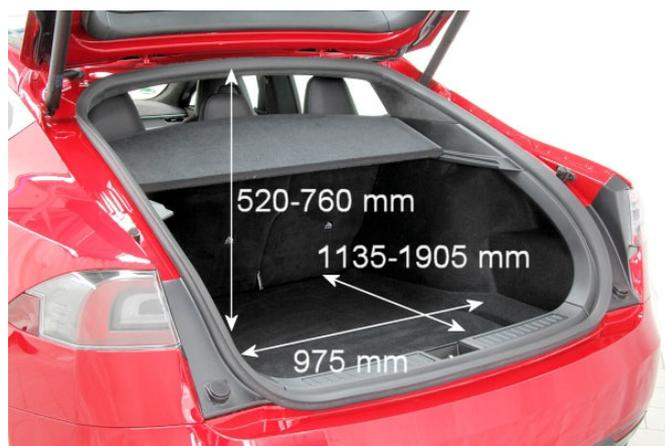
Der Kofferraum bietet 435 l Volumen, zusätzlich stehen 70 l unter der Fronthaube zur Verfügung.
