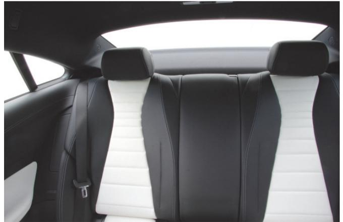
Breite Dachsäulen, die hoch angesetzte, schmale Heckscheibe und die nicht versenkbaren Kopfstützen schränken die Sicht nach hinten ein.
