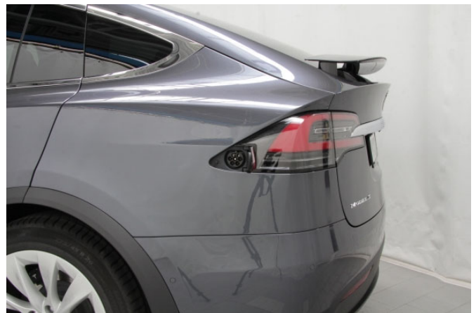
Der Ladeanschluß versteckt sich unsichtbar unter der linken hinteren Leucheneinheit.
