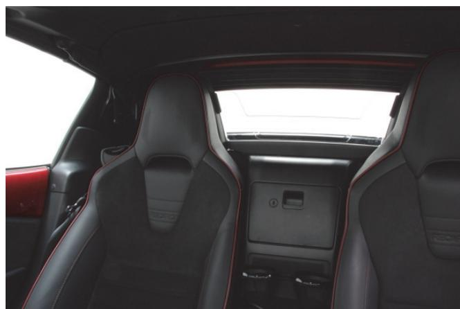
Die sehr breiten Dachstützen schränken die Sicht nach schräg hinten erheblich ein.
