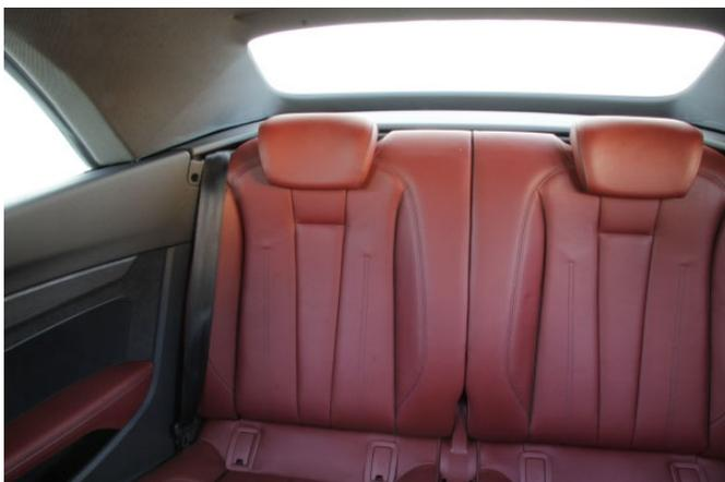
Trotz der versenkbaren Kopfstützen im Fond ist die Sicht nach schräg hinten durch die breiten Bereiche des Verdecks und das kleine Heckfenster erheblich eingeschränkt.
