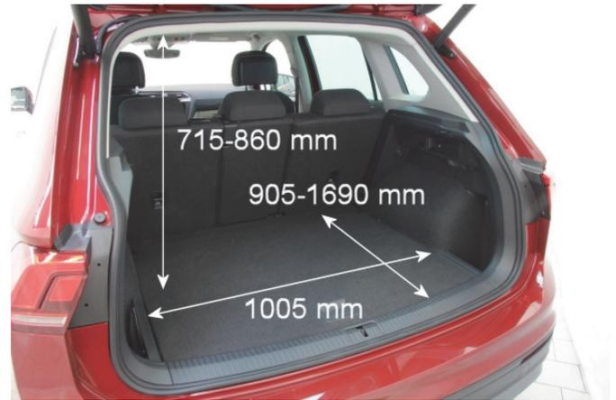
Der Kofferraum stellt hervorragende 465 l Volumen für das Gepäck zur Verfügung. Damit bietet er 25 l mehr Platz als die erste Generation des Tiguan.
