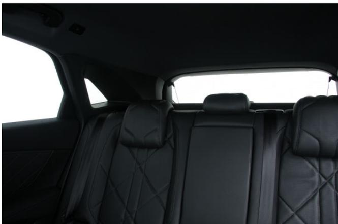
Sehr breite Dachsäulen, die nicht versenkbare mittlere Fondkopfstütze und die schmale, hoch angesetzte Heckscheibe schränken die Sicht nach hinten erheblich ein. Die aufpreispflichtige Rückfahrkamera ist beim DS 7 eine sinnvolle Investition.
