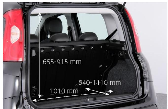
Aufgrund der zusätzlich verbauten Gastanks bietet der Kofferraum mit 180 l Volumen um 40 l weniger Platz fürs Gepäck als Modelle ohne Erdgasanlage.
