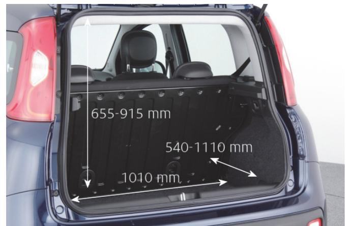
Aufgrund der angebrachten Gastanks bietet der Kofferraum mit 180 l Volumen um 40 l weniger Platz fürs Gepäck als Modelle ohne Autogasanlage.
