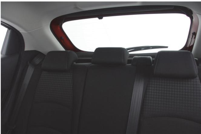
Massive Dachsäulen und ein kleines, hoch angesetztes Heckfenster beeinträchtigen die Sicht nach hinten.
