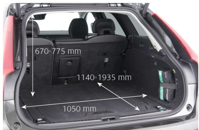
Für eine Kombilimousine mit einer Gesamtlänge von fast fünf Metern ist das Kofferraumvolumen von 415 l nicht gerade üppig bemessen.
