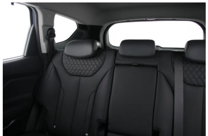
Die Sicht nach hinten kann aufgrund der breiten Dachsäulen und der nicht vollständig versenkbaren Kopfstützen nicht überzeugen. Hindernisse hinter dem Fahrzeug sind nur mittels der serienmäßig verbauten Rückfahrkamera gut zu erkennen.
